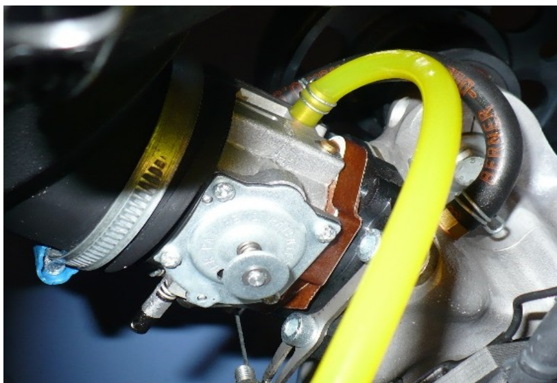
Ilustracja 7: Przycisk membrany gaźnika
